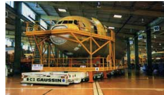
Самоходная многофункциональная тележка Отрасль: Аэрокосмическая промышленность Длина - 23,15 м. Ширина - 4 м. Г/п - 44,5 т.
