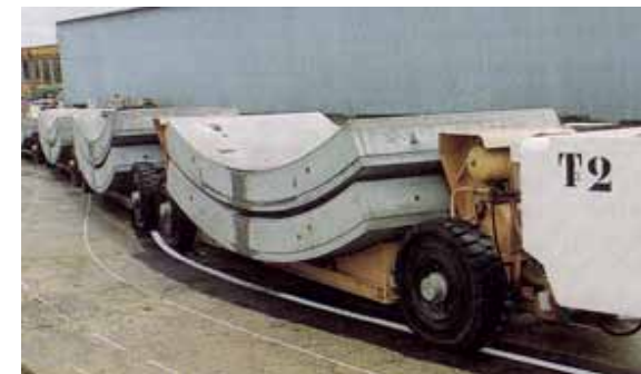
Автопоезд для транспортировки ЖБИ при строительстве туннелей. Длина - 87 м. Точность управления +/- 20 мм.
