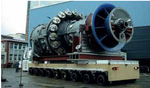
Самоходный прицеп (300 тонн) Отрасль: энергетика. Газовая турбина Точность позиционирования - 1 мм.
